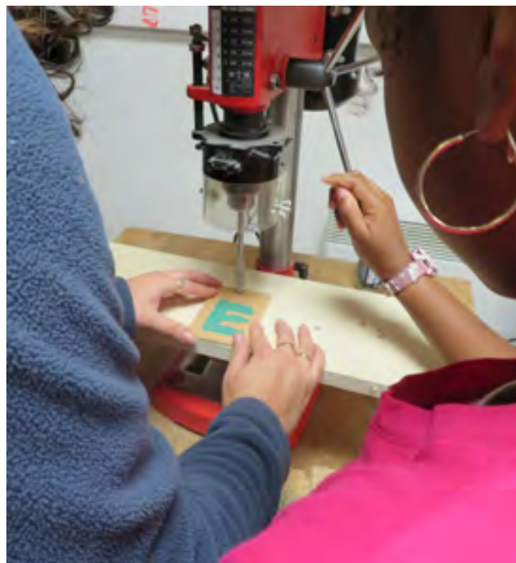
3 Ponçage des lettres et perçage des lettres à la perceuse à colonne
